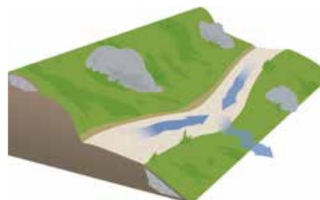
En sti som er lagt "bølgende" i terrenget gjør at vannet kun følger stien en kort strekning.
